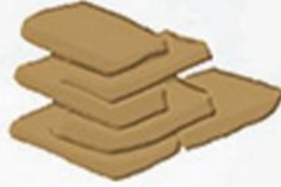
تشريك الحجارة L'ENCHEVETREMENT DES PIERRES
