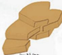
حجارة الربط Pierres de liaison (chainage)
