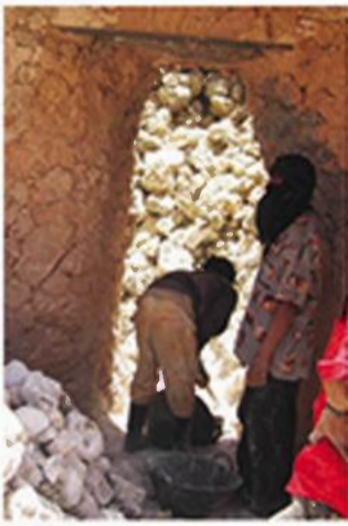
استخراج الكلس الحي Extraction de la chaux vive
